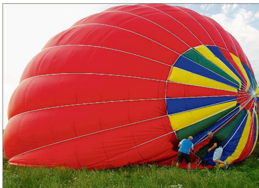
Eine Hülle mit beachtlichem Ausmaß: 2 500 Quadratmeter Stoff, 12 600 Kubikmeter Luftvolumen und 120 000 Euro teuer.
